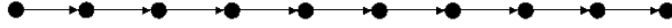
FIGURE 10 – Réseau en chaîne composé de 10 nœuds dans lequel le nœud i , ( i > 1 ) ne reçoit le signal que du nœud i - 1
